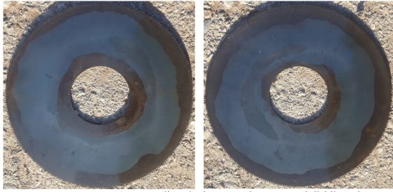
Rasm 1. 65G rusumli po'latdan tayyorlangan yangi diskli arralar
